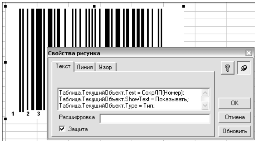
Рис. 1.2. Настройка параметров динамического формирования ActiveBarcode
