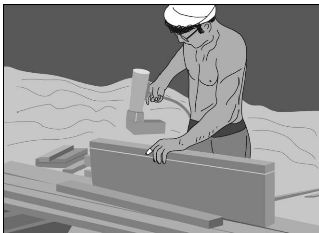
Рис. 3.23. Гвоздезабиватели могут быть использованы для сборки блоков торцевых досок
