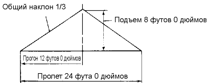
Рис. 4.31. Общий наклон 1/3 (Stanley Tools)
