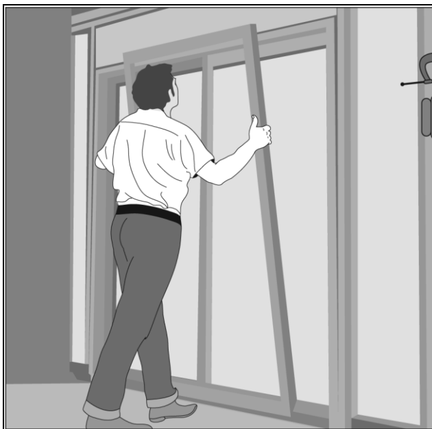
Рис. 6.146. Установка подвижной части двери на ребро металлической части нижней обвязки (Andersen)
