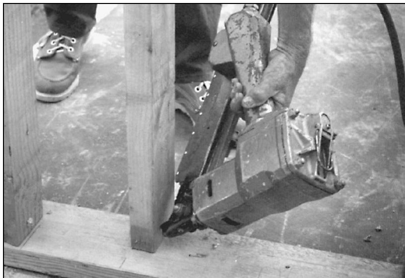
Рис. 2.9. Гвоздезабиватель используется для забивания гвоздей в бетонную плиту или кирпичную кладку под любым углом (Duo-Fast)
