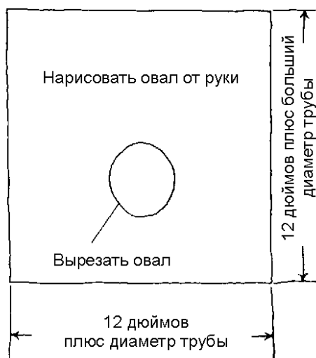
Рис. 5.52. Вырезание овала во фланце (Bird and Son)
