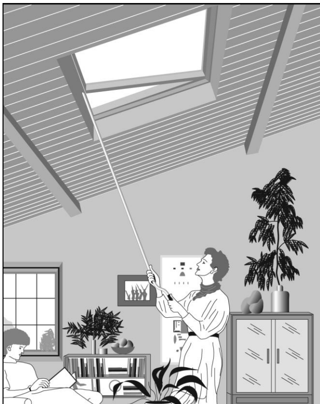
Рис. 6.52. Световой люк с возможностью открывания для вентиляции: а — общий вид и предварительно смонтированный люк (Novi); б — использование штанги с крючком для открывания светового люка (Velux-America)
