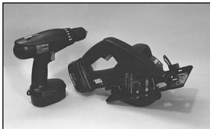
Рис. 1.43. В беспроводных дрели и пиле используются аккумуляторные батареи одного и того же типа и номинала
