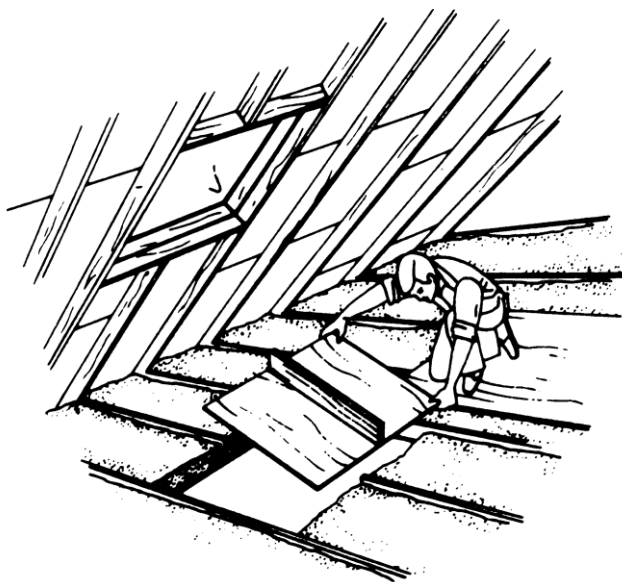
Рис. 6.64. Удаление части потолка (Novi)
