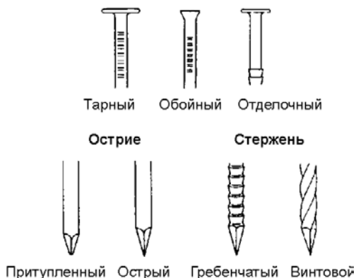
Рис. 7.56. Типы гвоздей (Western Wood Products)
