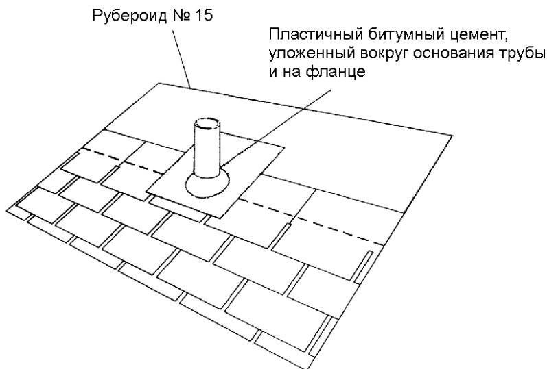
Рис. 5.53. Цементирование воротника вокруг трубы (Bird and Son)
