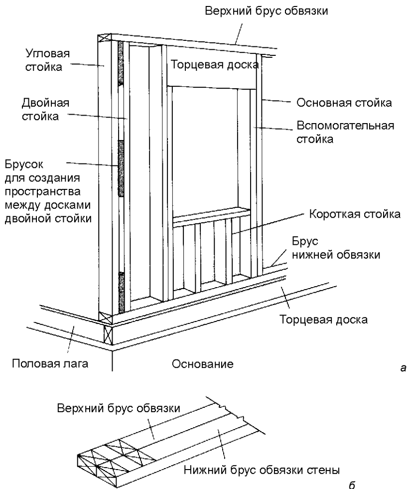
Рис. 3.8. Разметка стоек на углах: а — в собранном состоянии; б — разметка
