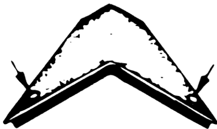
Рис. 5.75. Выполнить уплотнение каждого установленного элемента кровли конька с помощью эластомерного клея и зафиксировать все плитки двумя гвоздями (Ridglass)
