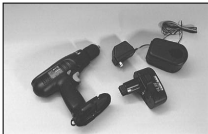
Рис. 1.44. Одно зарядное устройство может быть использовано для подзарядки аккумуляторных батарей пилы и дрели, если они имеют одно и то же рабочее напряжение
