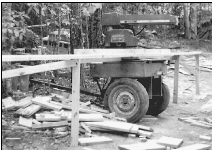
Рис. 3.18. Радиально-отрезной станок может быть установлен на строительной площадке
