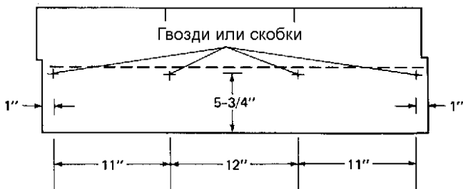
Рис. 5.28. Крепление гвоздями или скобками листов рубероидной плитки (Certain-Teed)
