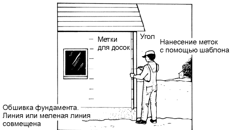
Рис. 7.48. Метки выполняются, чтобы ровно уложить сайдинг вдоль длинных стен
