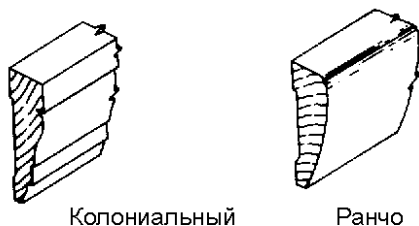
Рис. 6.103. Два популярных типа молдинга, используемых для отделки рамы двери
