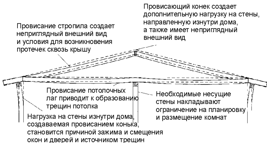
Рис. 4.10. Схема работы обычной рамной конструкции. Явно видны недостатки и предсказуемы проблемы в процессе эксплуатации
