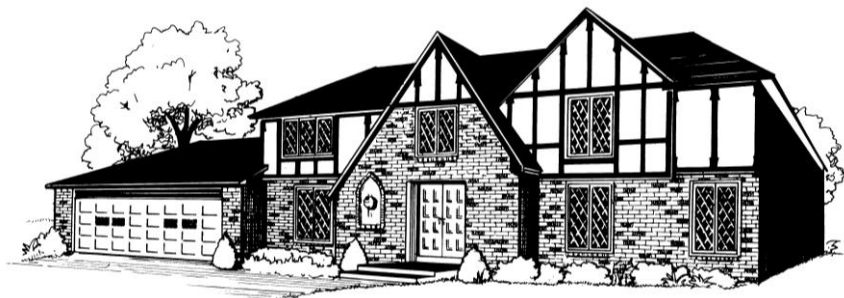
Рис. 6.16. Ромбическая расстекловка окон с помощью установленных пластиковых раскладок
