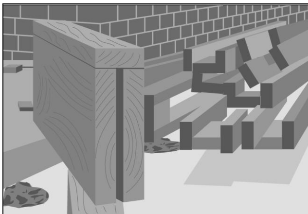
Рис. 3.22. Использование фанеры толщиной 1/2 дюйма для создания промежутка между торцевыми досками
