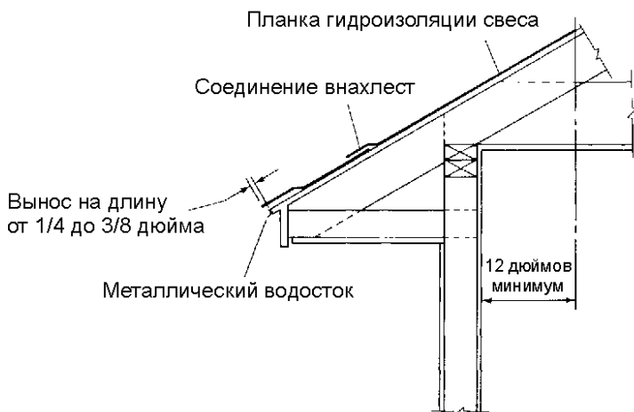
Рис. 5.57. Планка для гидроизоляции свеса крыши с нормальным наклоном. Это означает, что наклон составляет 4 дюйма или более (Bird and Son)
