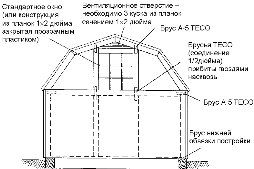
Рис. 4.118. Поперечный разрез сооружения с вентиляционным проемом (ТЕСО)
