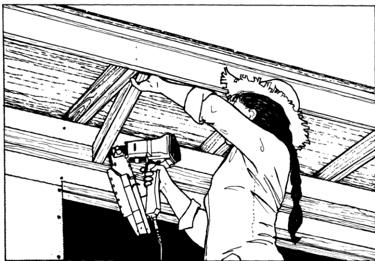
Рис. 4.2. Установка укосин (консолей) по месту (Duo-Fast)
