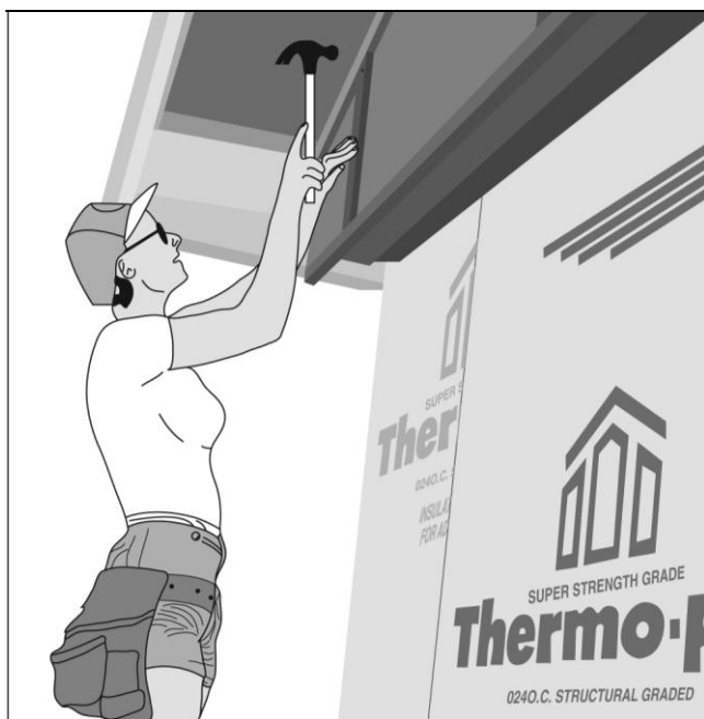
Рис. 7.38. Устройство сайдинга фронтона выполнено до устройства сайдинга стены (Fox and Jacobs)
