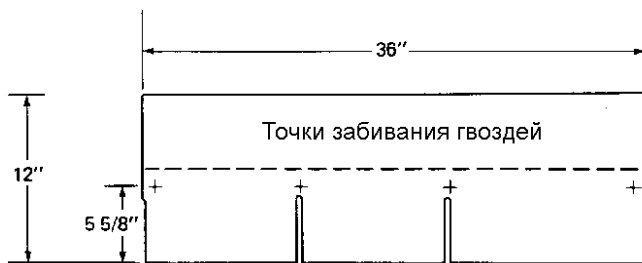
Рис. 5.29. Разметка забивания гвоздей на листе рубероидной плитки (Bird and Son)
