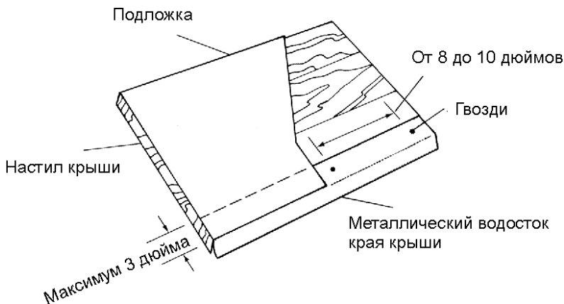
Рис. 5.55. Установка металлического водостока свесов прямо на настил (Bird and Son)
