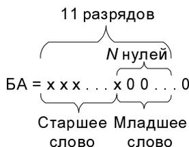
**Рис. 8.30.** Формирование базового адреса
