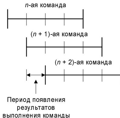
**Рис. 2.7.** Конвейерный способ выполнения команд
