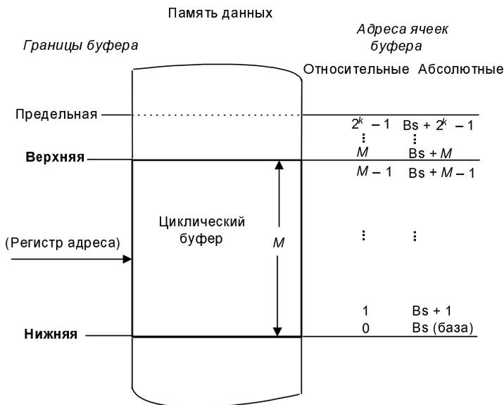
Рис. 5.24. Циклический буфер
