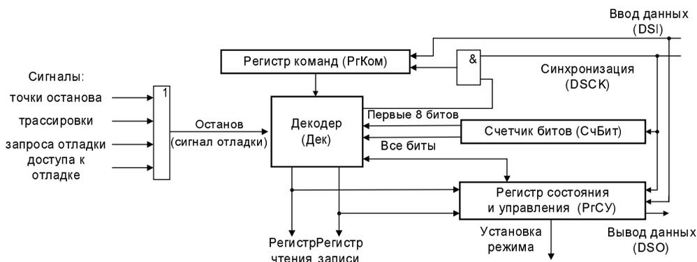
**Рис. 10.6.** Контроллер и последовательный интерфейс OnCE
