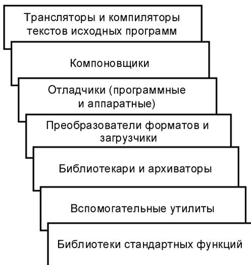
**Рис. 9.2.** Состав типового пакета программного обеспечения поддержки разработки
