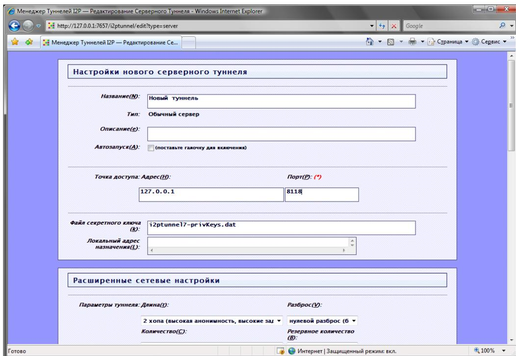
Рис. 3.17. Создание серверного туннеля к Tor
