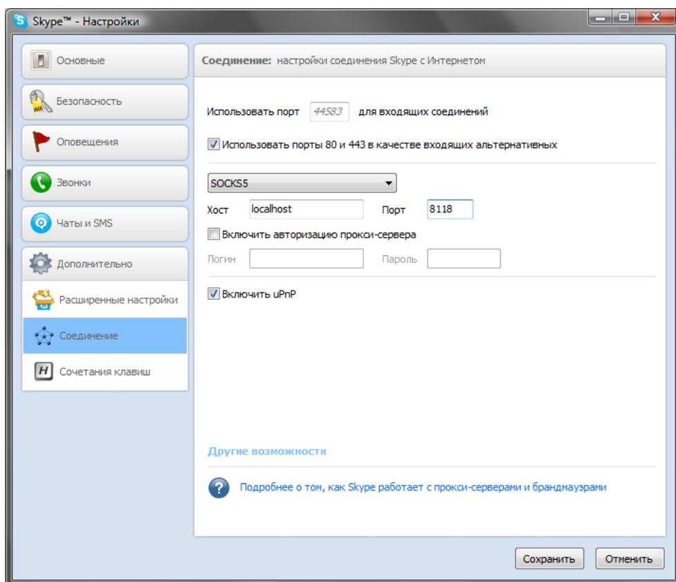
Рис. 2.14. Настраиваем Skype на использование Tor
