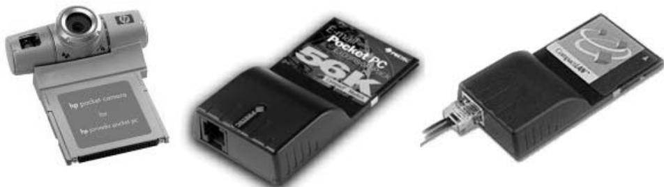
**Рис. 2.32.** Внешние устройства стандарта CompactFlash (слева направо — цифровая камера, модем и сетевая карта)
