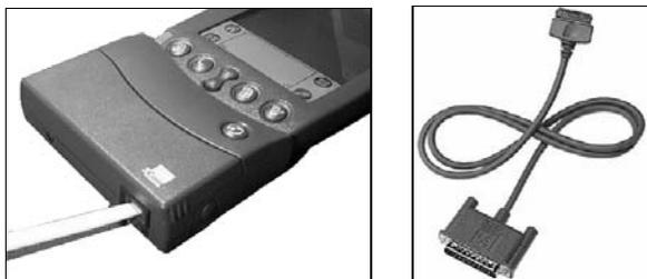
**Рис. 2.26.** Модем для КПК Palm и кабель для подключения внешнего модема
