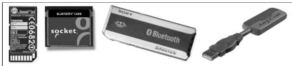
Рис. 2.28. Bluetooth-модули стандартов SD, CF, Memory Stick и USB (слева направо)
