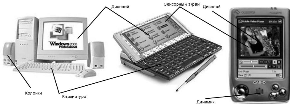
**Рис. 1.1.** Компоненты настольного и карманного компьютеров
