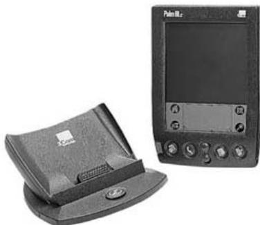
**Рис. 3.1.** КПК Palm III и подставка синхронизации
