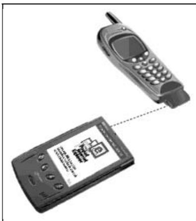
**Рис. 2.24.** Подключение телефона к КПК через ИК-порт
