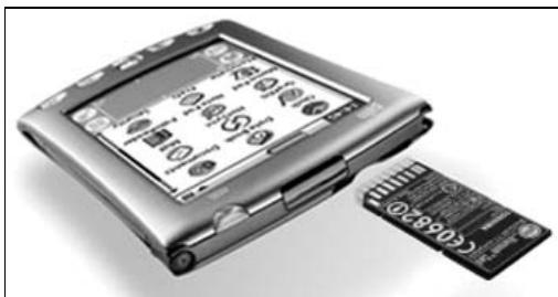
Рис. 2.29. Подключение Bluetooth-модуля к КПК Palm
