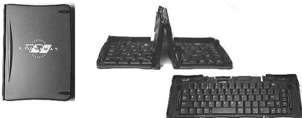
**Рис. 2.13.** Внешняя клавиатура Palm Portable Keyboard
