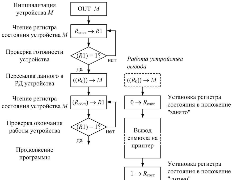
**Рис. 5.17.** Взаимодействие центрального процессора с устройством вывода на печать
