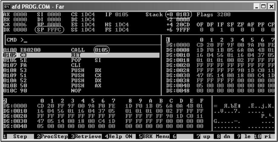
Рис. 6.2. Вызов процедуры с занесением в стек адреса возврата из нее
