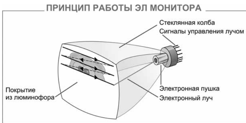
Рис. 2.4. Принцип работы электронно-лучевого монитора
