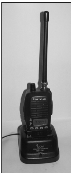
Рис. 3.8. Портативная радиостанция Iscom V8 в зарядном стакане, к которому подается сетевое напряжение 220 В через сетевой адаптер
