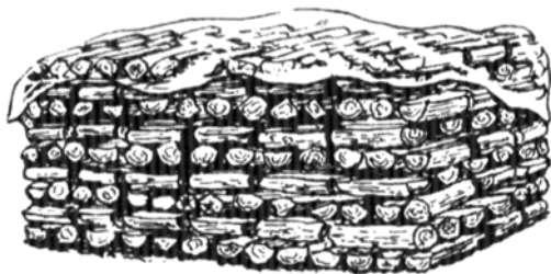
Рис. 2.15. Схема складирования дров в поленницу под открытым небом
