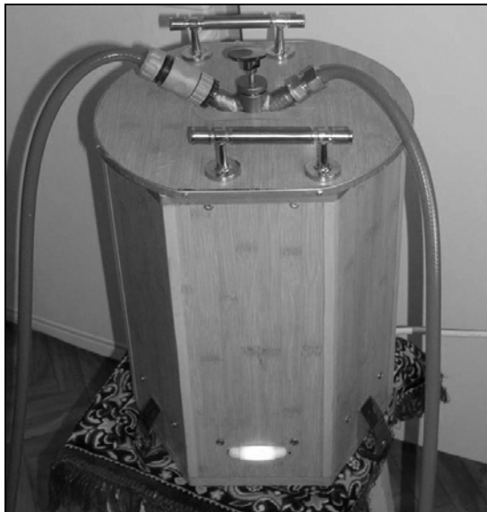
Рис. 3.6. Мобильный водонагреватель для деревенского дома
