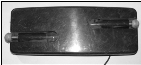
Рис. 3.5. Комнатная антенна «Маяк-2» метрового диапазона со сложенными «усами»
