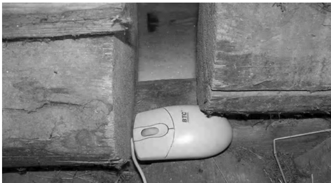
Рис. 3.15. Компьютерная мышь в качестве датчика оседания дома
