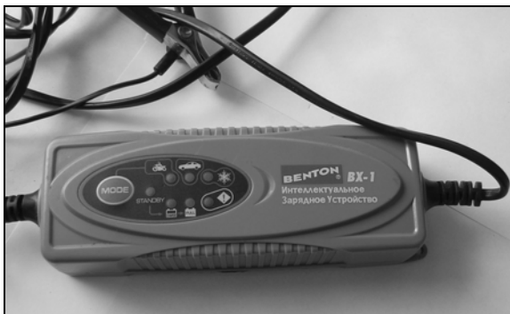
Рис. 3.10. Автоматическое «интеллектуальное» импульсное зарядное устройство Benton BX-1
