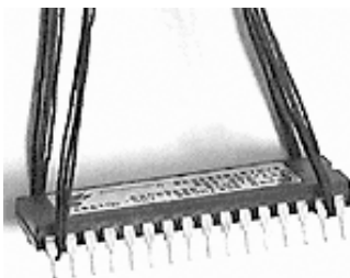
Рис. 15.4. Обвяжите микросхему нитками так, чтобы они случайно не соскользнули
