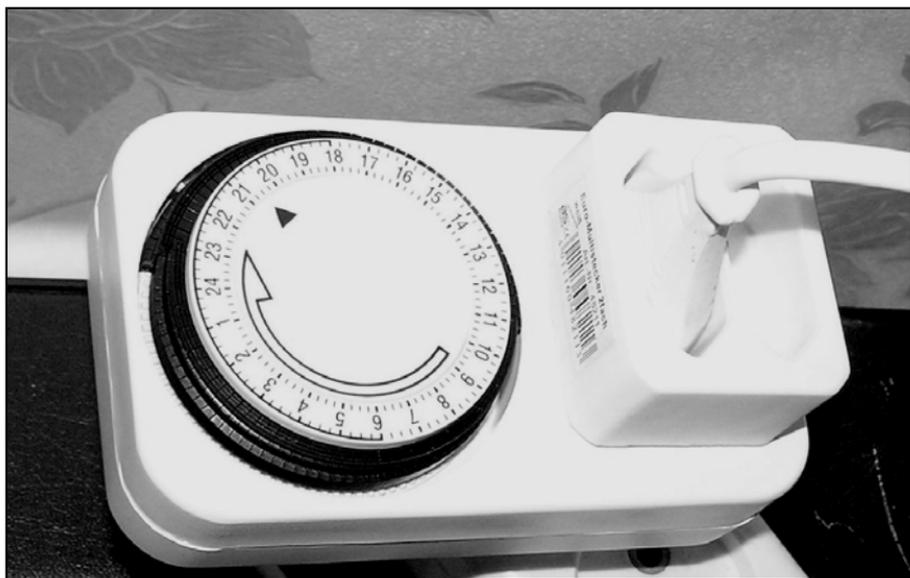
Рис. 4.18. Электронный программируемый таймер — реле времени
