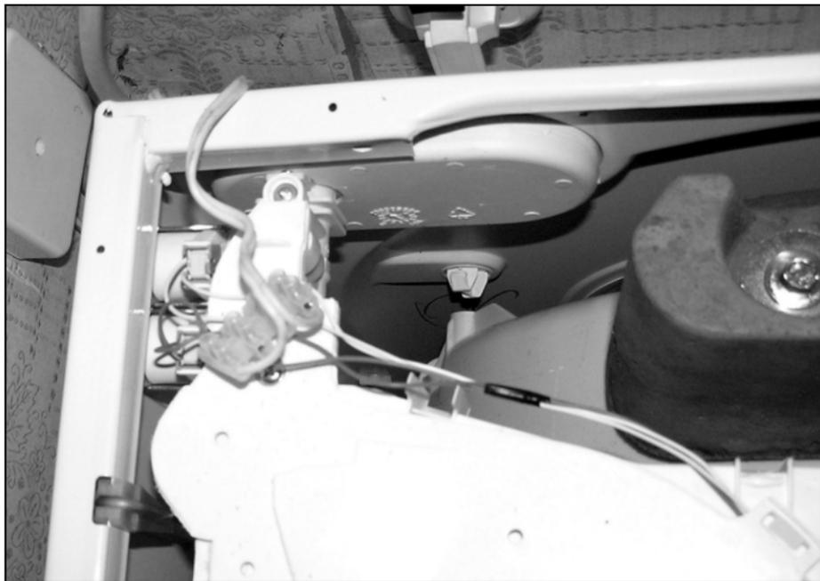
Рис. 3.18. Крышка стиральной машины снята, клеммник подключен
