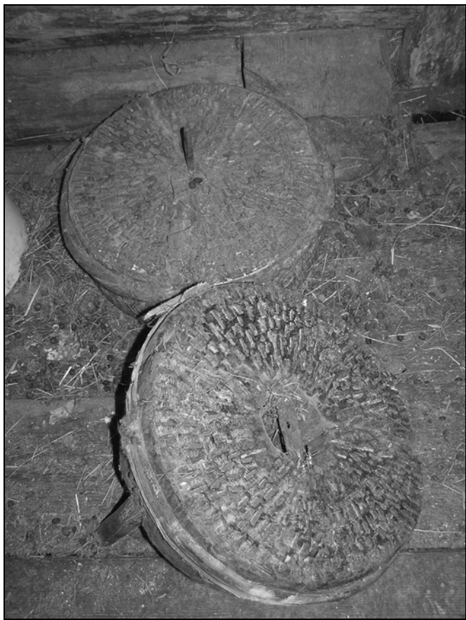
Рис. 2.30. Внутреннее устройство старинной зерновой мельницы
