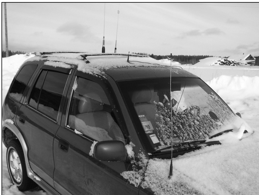
Рис. 4.8. Готовая GSM-антенна на крыше автомобиля (она самая короткая)
