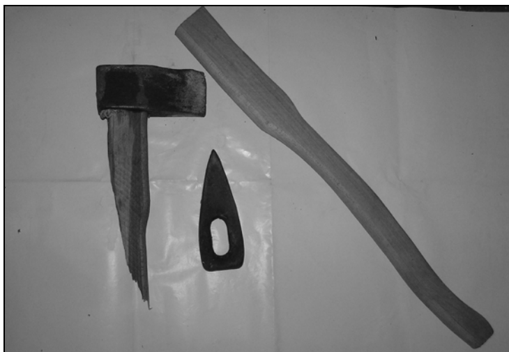
Рис. 2.2. Составные части топора-колун
