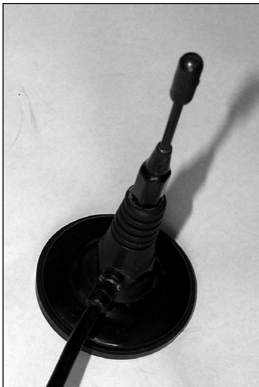
Рис. 4.2. Простая автомобильная антенна диапазона 900 МГц
