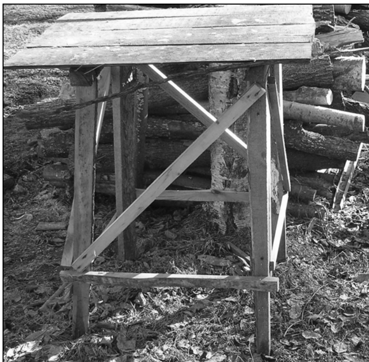
Рис. 2.1. Верстак фермера: а — примерная схема; б — реальный верстак, который сделан мной за полдня и который я рекомендую фермерам
