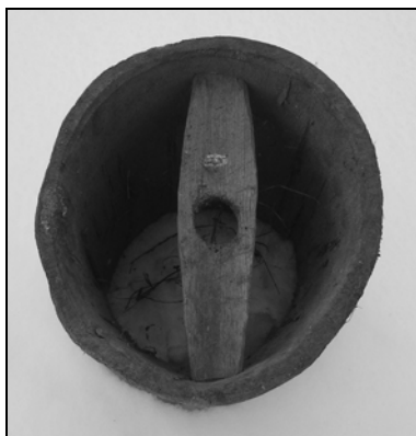
Рис. 2.3. Барабан для трепания волокон льна
