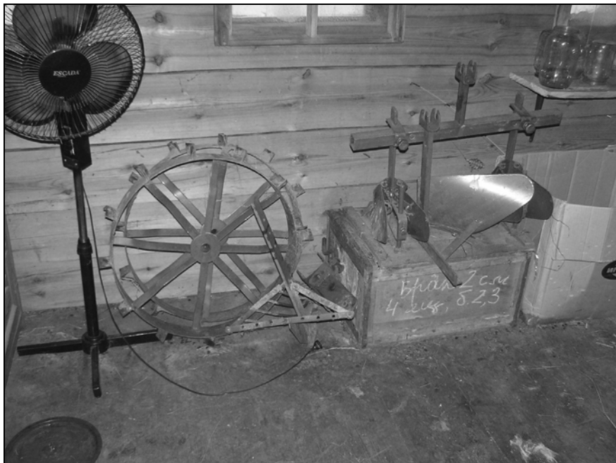
Рис. 2.44. Колеса для окучника, грунтозацепы и навес для боронения, а также вспашки — все это навесное оборудование к трактору Т-25 или мотоблоку типа МБ-2
