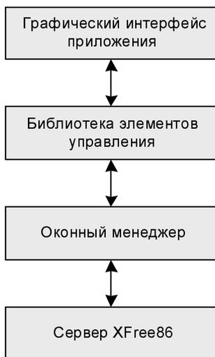
Рис. 2.1. Структура графической системы Linux
