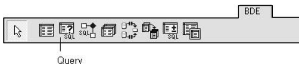
Рис. 2.18. Компонент Query обеспечивает выбор информации из базы данных
