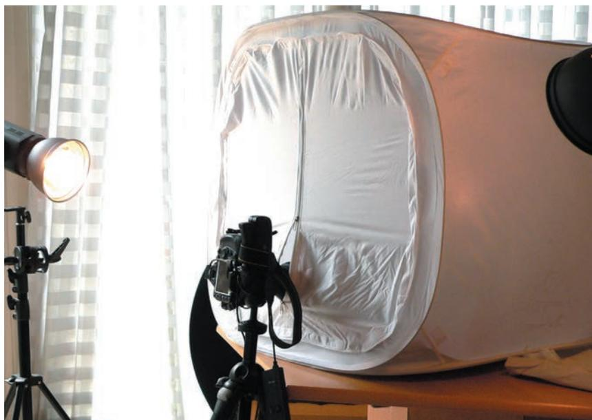
*Так выглядела съемочная площадка для получения снимка стеклянного графина. Объектив камеры был просунут через переднее отверстие бестеневой палатки, которое затянули настолько плотно, насколько возможно.*
