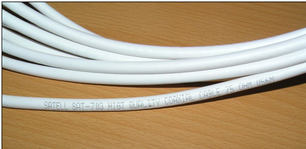
Рис. П12.1. Фото куска кабеля CAT703 китайского производства
