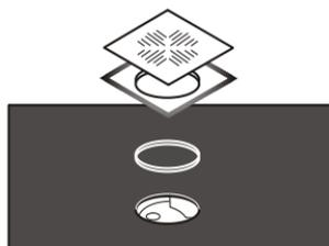
2. Выполнить уплотнение трапа с помощью зажимного кольца. Установить четырехугольную крышку с корпусом на место.
