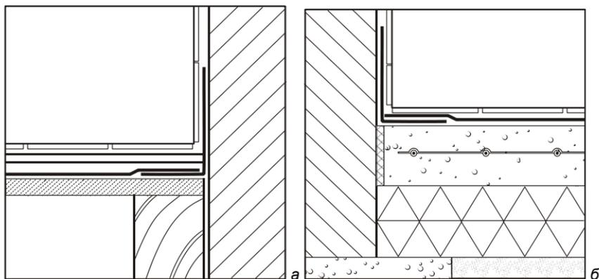
**Рис. 2.4.** Детали устройства гидроизоляции «MustaPekka» по плите перекрытия (а) и по монолитной фундаментной плите (б):
