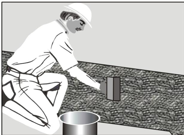
Рис. 2.2. Нанесение гидроизоляционного материала «Hidrotes-94»
