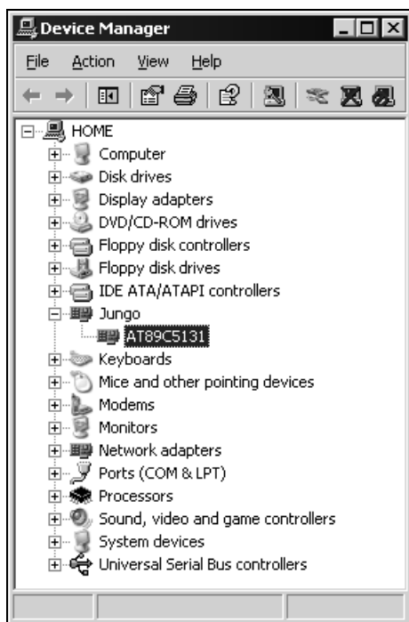
Рис. 13.8. Новое устройство — загрузчик AT89C5131
