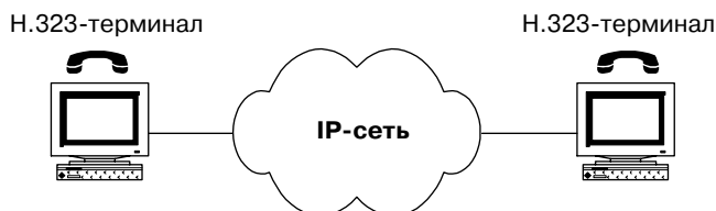
Рис. 2.2 Упрощенный сценарий IP-телефонии "компьютер-компьютер" (аналог рис.2.1)
