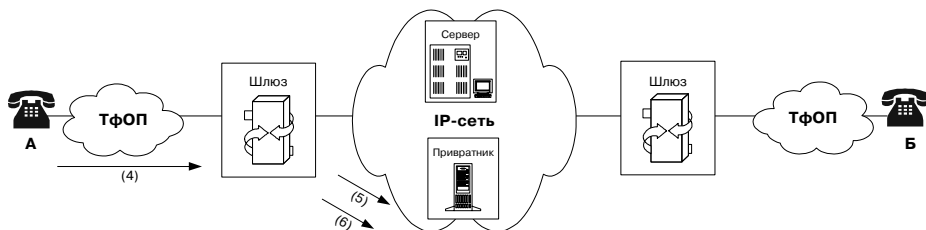
Рис. 2.11 Установление соединения: Часть 2
