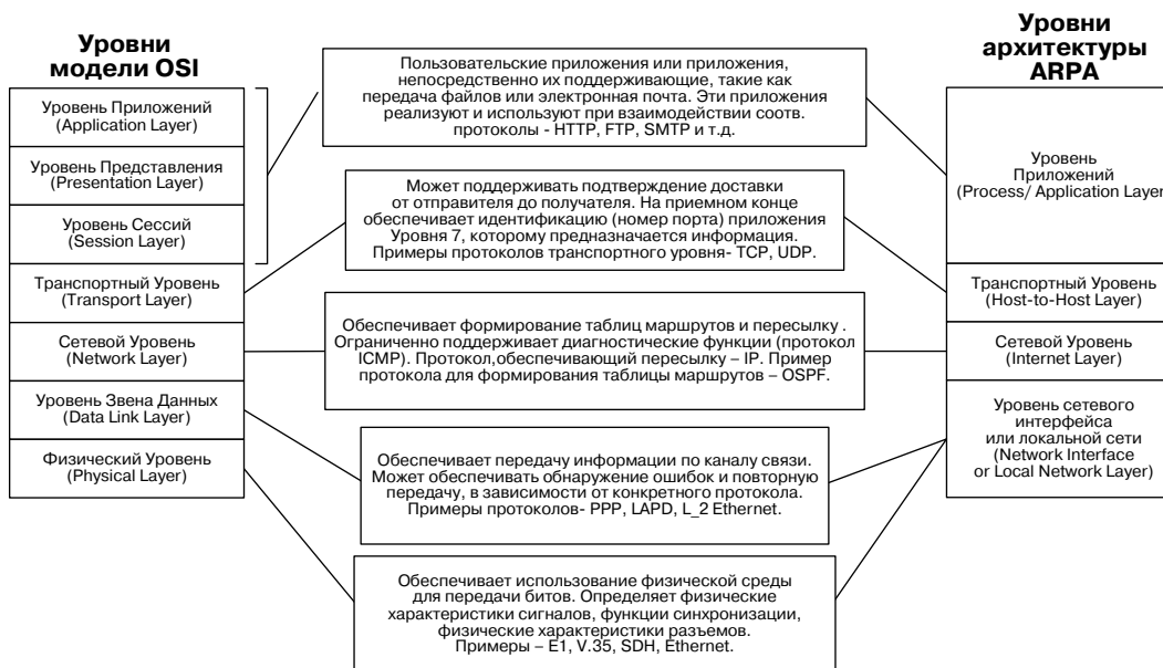
Рис. 4.1 Уровни модели OSI и архитектуры Интернет
