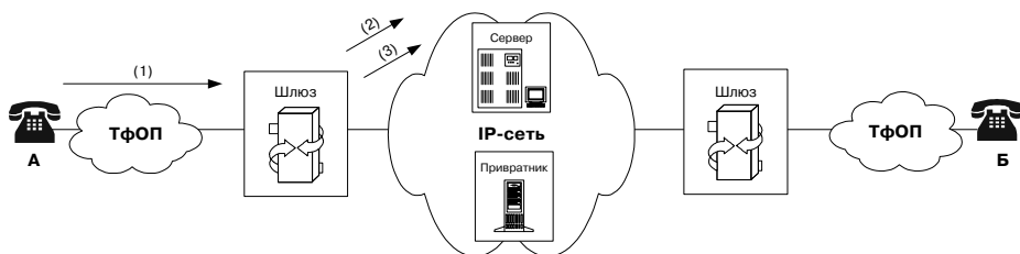
Рис. 2.10 Установление соединения: Часть 1
