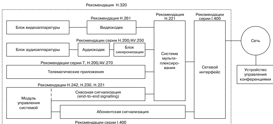
Рис. 5.1 Система видеоконференций в узкополосной ISDN
