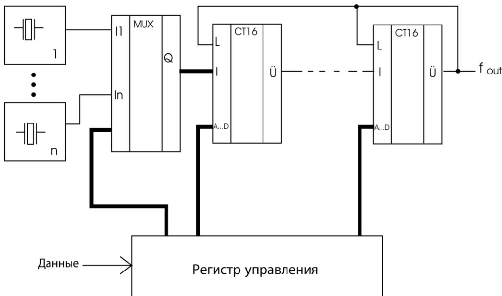
Рис. 15.2. Регулируемый генератор
