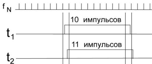
Рис. 16.2. Происхождение погрешности дискретизации
