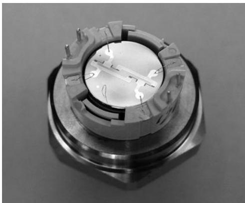
Рис. 6.8. Конструкция пьезорезистивного датчика
