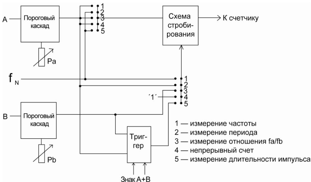
Рис. 16.3. Принципиальная схема коммутации способов измерения
