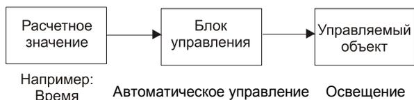
**Рис. 2.2.** Система управления освещением
