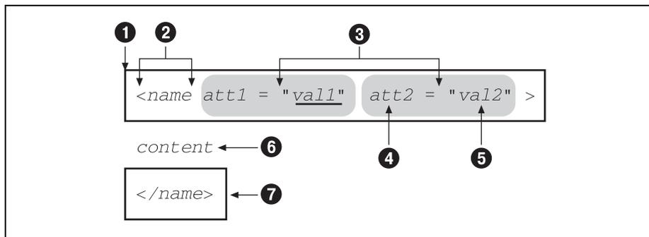
Рис. 2.7. Синтаксис элемента-контейнера
