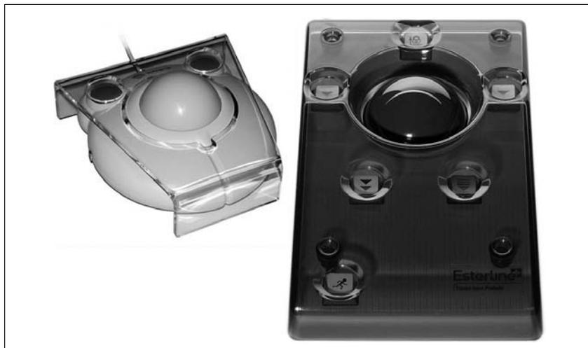
Рис. 2.16. Трекболы специальной конструкции
