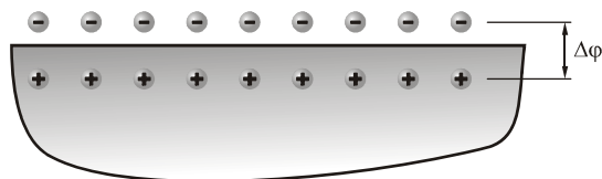
Рис. 8.5. Двойной электрический слой на поверхности металлов
