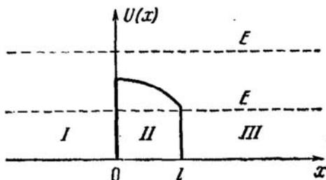
Рис. 4. Движение частицы при наличии потенциального барьера.
