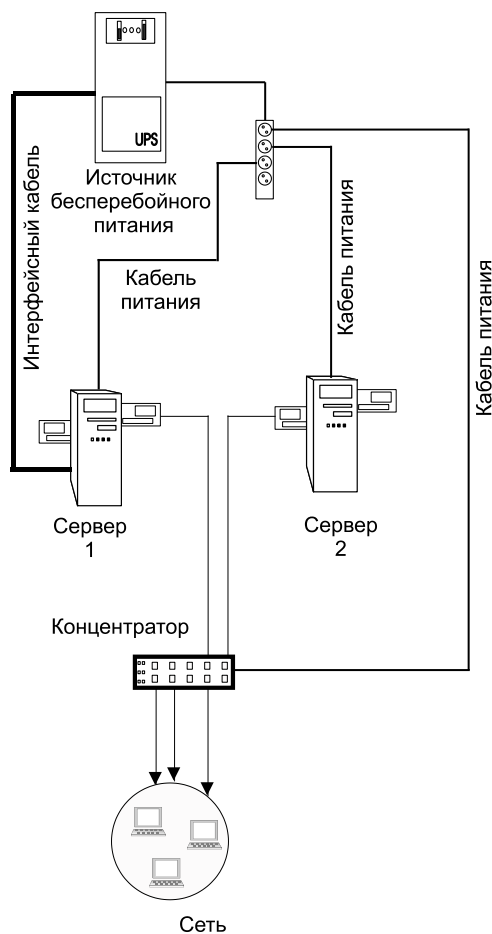
Рис. 8.1. Организация бесперебойного питания серверов
