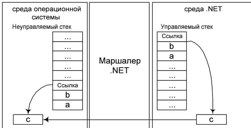
Рис. 14.13. Передача параметров по ссылке
