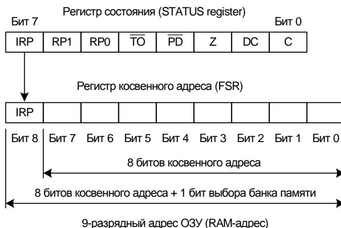
**Рис. 1.7.** Структура RAM-адреса для косвенной адресации
