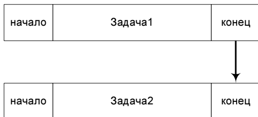
Рис. 4.32. Тип связи "Окончание-Окончание"
