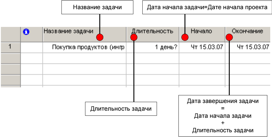
Рис. 4.14. Принцип расчета MS Project даты окончания задачи
