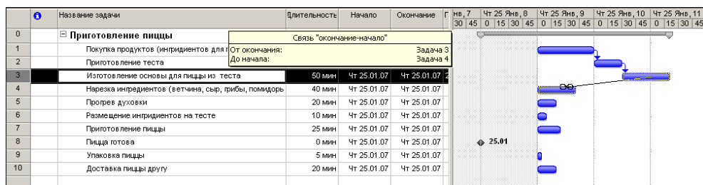
Рис. 4.38. При создании связи в графической части диаграммы Ганта курсор приобретает вид знака бесконечности
