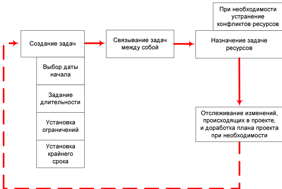
Рис. 5.136. Схема составления проекта
