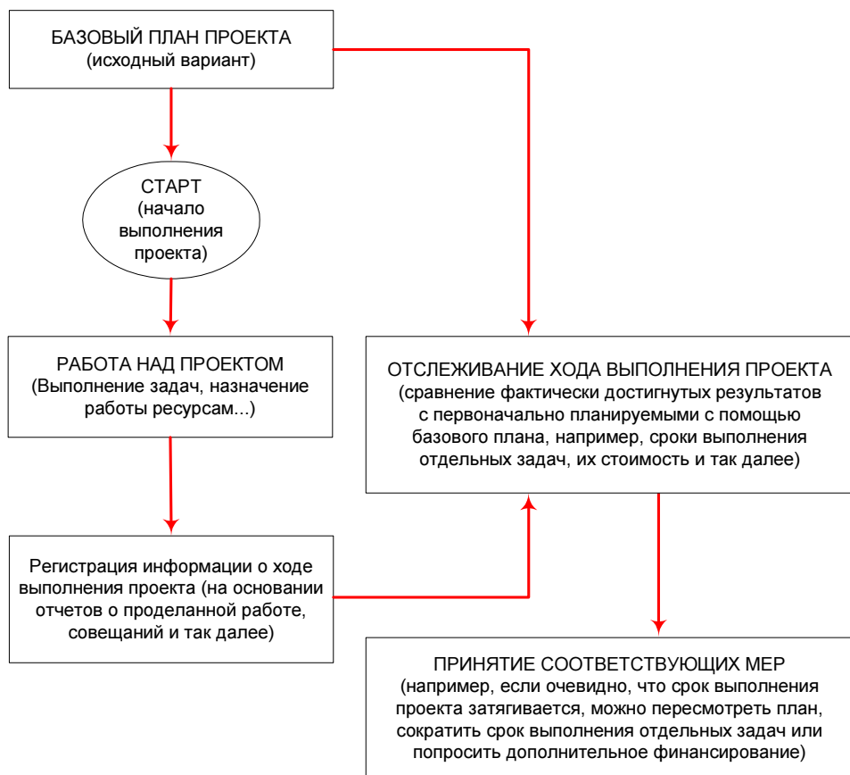
Рис. 5.155. Общая схема работы с базовым планом
