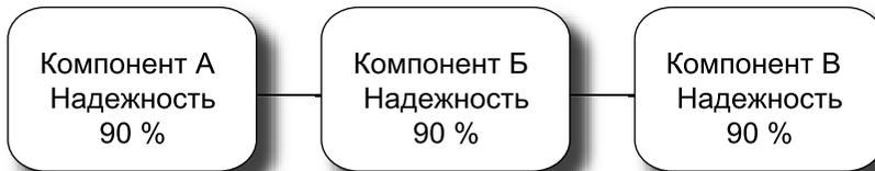
Рис. 6.1. Система из трех компонентов
