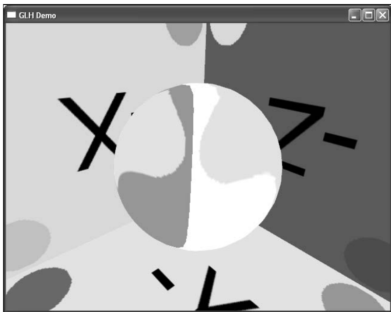
Рис. 10.18. Искажение отражения при необнуленных коэффициентах матрицы, отвечающих за перемещение
