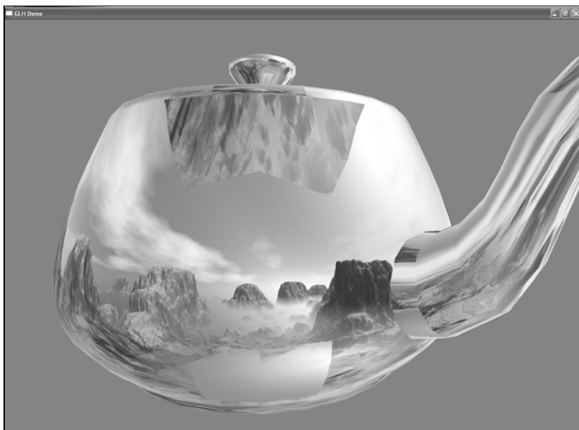
Рис. 10.14. Некорректное отражение в чайнике из-за ошибки в библиотеке NV_DDS
