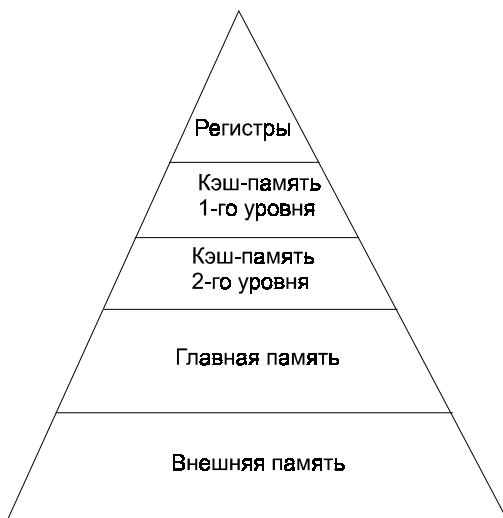
Рис. 1.8. Иерархия памяти компьютера
