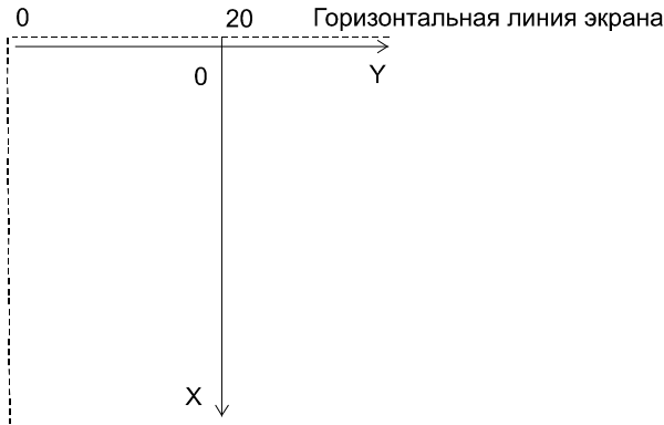
Рис. 2.24. Взаимное расположение экрана и осей координат
