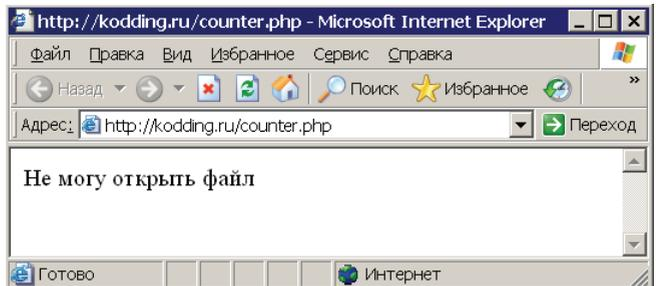
Рис. 6.7. Результат срабатывания защитного механизма в лице функций `die()` при неудачной попытке открыть файл counter.php
