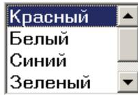
Рис. 7.20. Список с фиксированным числом видимых элементов
