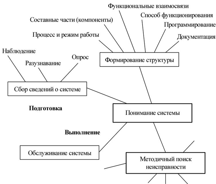
Рис. 3.1. Структурная схема поиска неисправности
