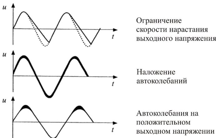
Рис. 5.32. Выходные сигналы неисправного операционного усилителя
