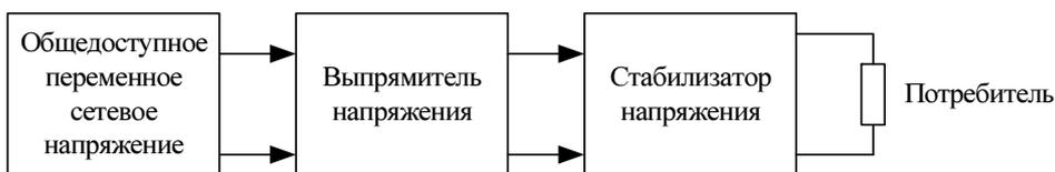
Рис. 9.1. Блок-схема источника питания
