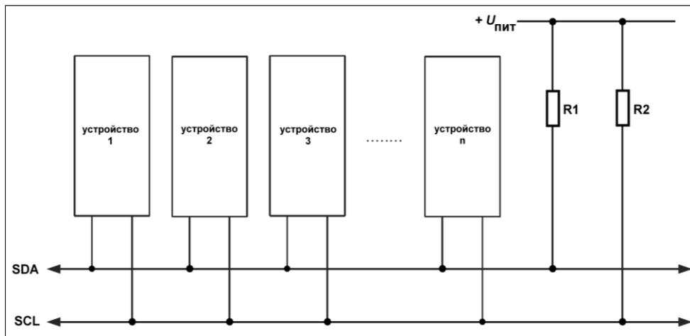
Рис. 12.1. Соединение устройств по интерфейсу I<sup>2</sup>C (общий провод не показан)
