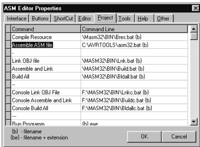
Рис. 5.1. Настройка редактора ASM Editor
