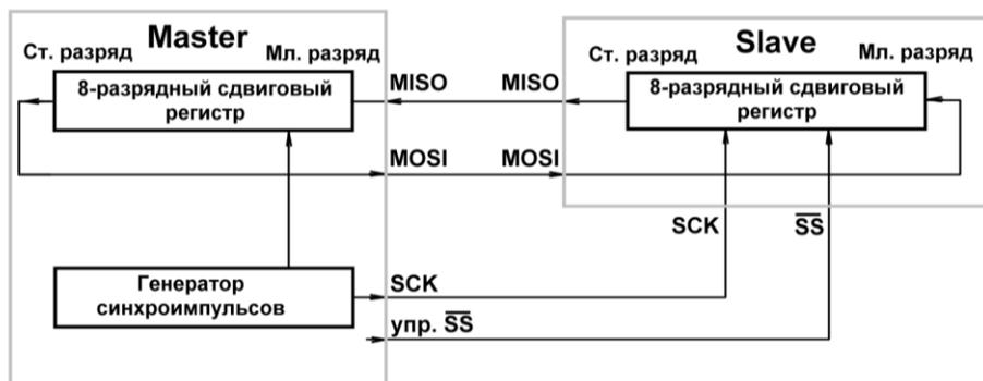
Рис. 3.2. Схема передачи данных по интерфейсу SPI
