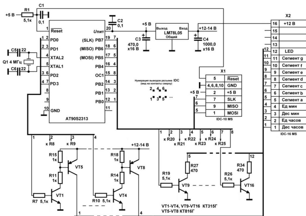
Рис. 8.5. Схема управления для индикации времени
