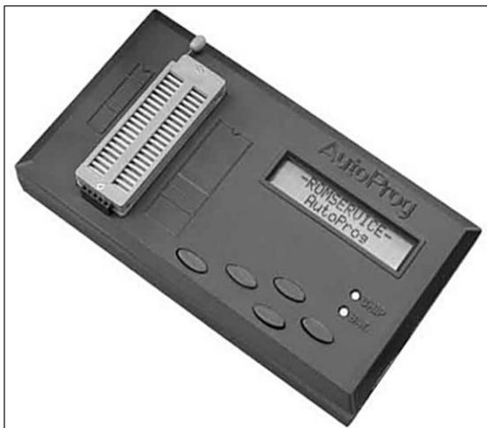
Рис. 5.2. Параллельный программатор AutoProg
