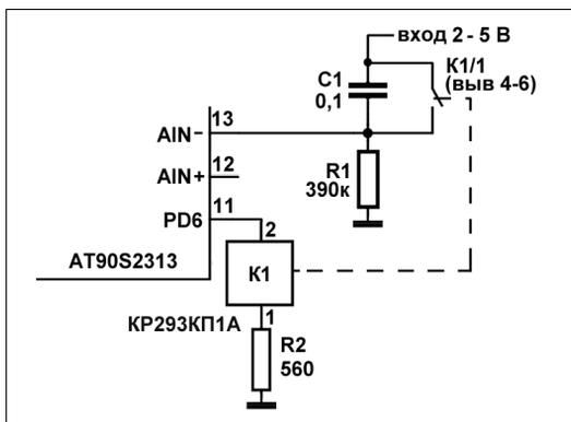
Рис. 10.3. Вариант АЦП однократного интегрирования на встроенном компараторе
