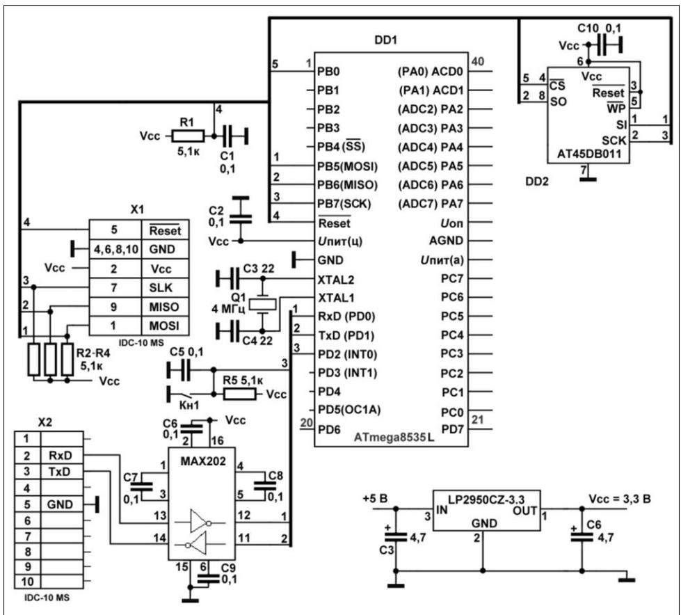
Рис. 11.2. Схема для тестирования процедур записи и чтения flash-памяти 45DBxxxВ по последовательному интерфейсу SPI
