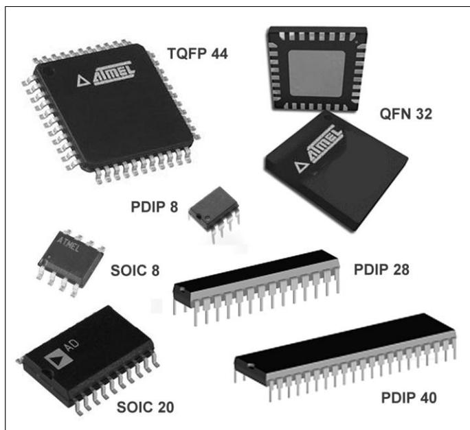
Рис. 1.1. Примеры различных типов корпусов для МК AVR
