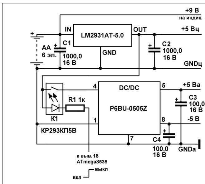
Рис. 14.1. Батарейный источник питания для питания цифровой и аналоговой частей, а также индикатора
