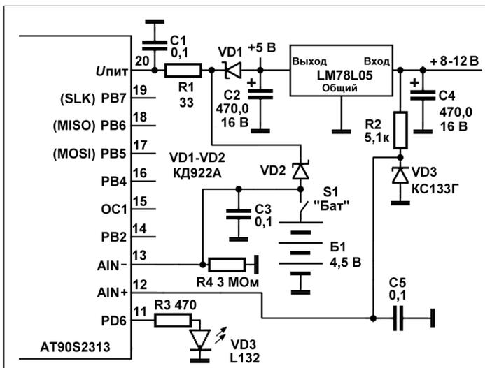
Рис. 10.2. Схема отслеживания напряжения резервной батареи на примере контроллера AT90S2313
