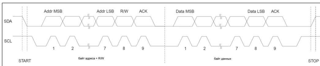
Рис. 12.2. Обмен информацией по интерфейсу I<sup>2</sup>C
