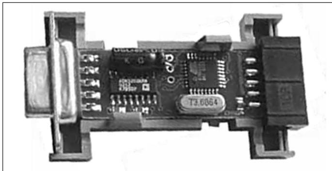
Рис. 5.3. Программатор AS-2 фирмы Argussoft в разобранном виде
