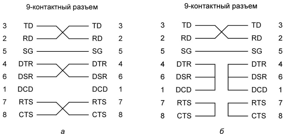
**Рис. 2.3.** Нуль-модемное соединение:
