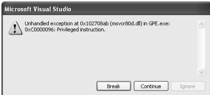
**Рис. 3.15.** Ошибка программы при попытке записи в регистр параллельного порта
