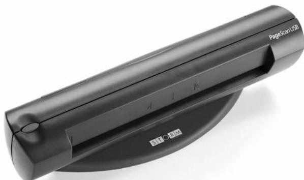
В новом сканере Logitech под кодовым названием «Peacock» были применены технологии сканирования нового поколения, а само устройство подключалось к компьютеру через новый порт USB. Этот недорогой продукт, по форме и размерам напоминающий свернутую газету, удобен и не занимает много места на столе. В прорезь сканера можно вставить любую страницу, после чего небольшой двигатель протягивает страницу через сканер, при этом происходит считывание изображения.
