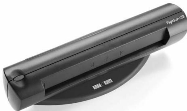
В новом сканере Logitech под кодовым названием «Peасock» были применены технологии сканирования нового поколения, а само устройство подключалось к компьютеру через новый порт USB. Этот недорогой продукт, по форме и размерам напоминающий свернутую газету, удобен и не занимает много места на столе. В прорезь сканера можно вставить любую страницу, после чего небольшой двигатель протягивает страницу через сканер, при этом происходит считывание изображения.
