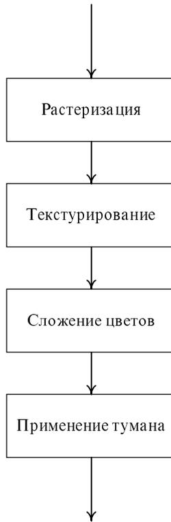
**Рис. 2.10.** Конвейер рендеринга
