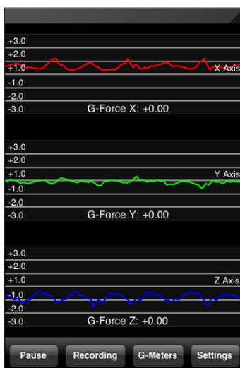
Рис. 1.14. Тестирование акселерометра при ходьбе с помощью AccelGraph
