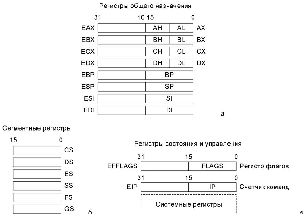
Рис. 2.4. Регистры микропроцессоров семейства Intel 80x86
