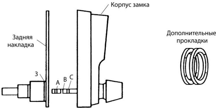
Рис. 8.14. Регулировка замка в соответствии с толщиной двери
