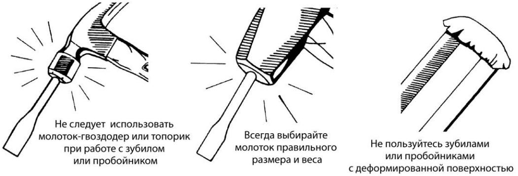
**Рис. 5.2.** Чтобы работать эффективно и не нанести себе травму, необходим подходящий инструмент (С разрешения компании Vaughan & Bushnell Manufacturing Company)
