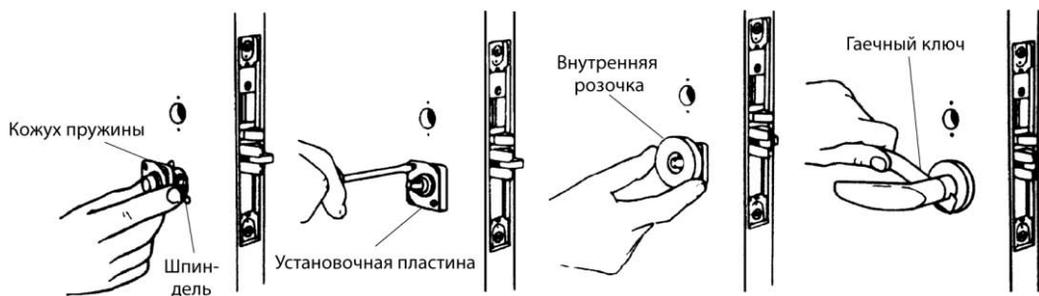
**Рис. 6.33.** Установка внутренней декоративной накладки
