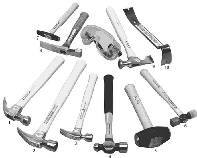
**Рис. 5.1.** Каждому слесарю-замочнику необходим набор молотков и фомок: 1 — обычный молоток-гвоздодер; 2 — молоток для вырубки; 3 — молоток для чистовой обработки; 4 — молоток с шаровым и фасонным бойком; 5 — молоток для пробойника; 6 — молоток с мягкими насадками на бойке; 7 — магнитный молоток для гвоздей с большой шляпкой; 8 — молоток для каменщика; 9 — молоток для гипсокартона (сухой штукатурки); 10 — фомка
