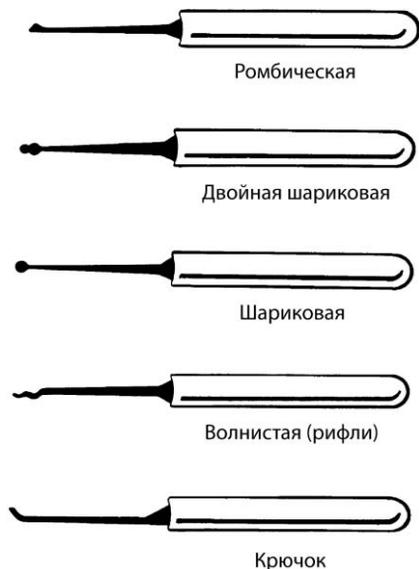
Рис. 9.1. Некоторые стандартные отмычки для замков (С разрешения компании A-1 Security Manufacturing Corp.)
