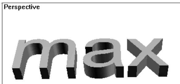
Рис. 8.14. Пример выдавливания плоской формы
