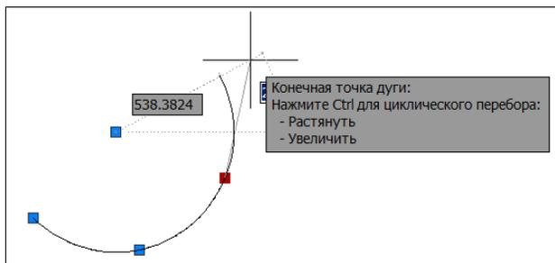
Рис. 4.11. Увеличение дуги с помощью конечной ручки
