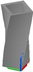
Рис. 10.68. Сдвиг с закручиванием
