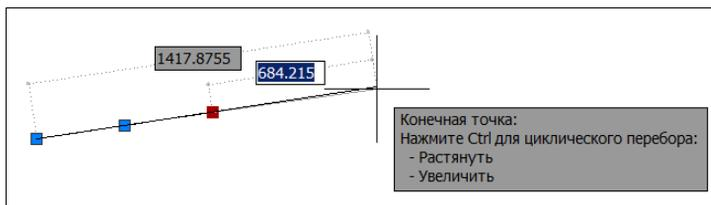
**Рис. 4.6.** Увеличение отрезка с помощью конечной ручки
