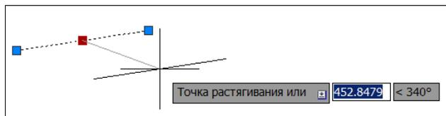
Рис. 4.7. Перенос отрезка с помощью средней ручки
