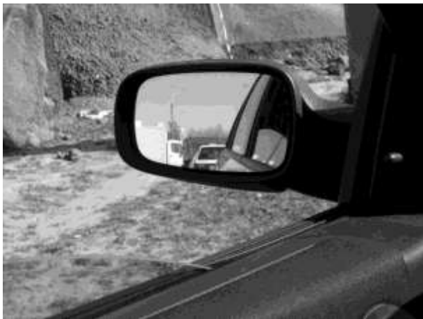
Рис. 2.16. Зеркало заднего вида имеет ограниченный обзор
