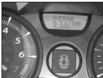
Рис. 1.11. Бортовой компьютер показывает: текущий расход топлива — 8,3 л/100 км
