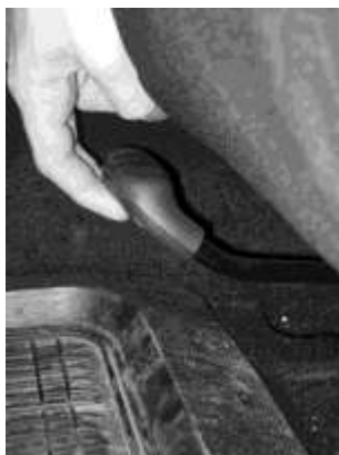
Рис. 1.8. Рычаг регулировки водительского сиденья по горизонтали
