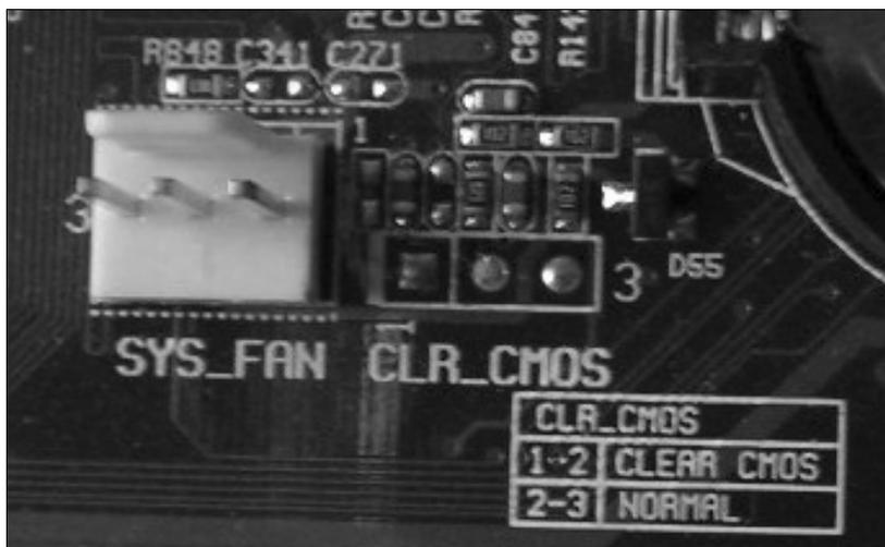
Рис. 2.2. Перемычка для сброса настроек может и отсутствовать
