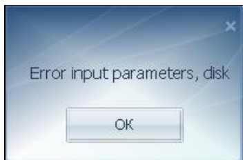
Рис. 3.51. Программа HDDScan v3.1 не может сканировать винчестеры, объединенные с помощью RAID-контроллера. Фиксируется состояние ошибки по входным параметрам диска — Error input parameters, disk
