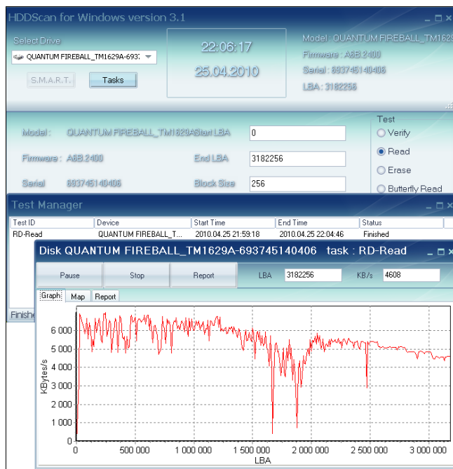
Рис. 5.25. Скорость чтения блоков информации для винчестера типа Quantum Fireball TM 1629A с объемом памяти 1,5 Гбайт. График получен с помощью программы HDDScan v3.1
