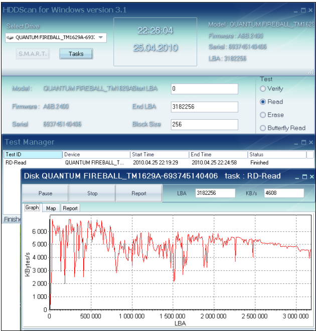
Рис. 5.27. Скорость чтения блоков информации для винчестера типа Quantum Fireball TM 1629A с объемом памяти 1,5 Гбайт. График получен с помощью программы HDDScan v3.1. Эксперимент был начат через 15 минут после получения результатов, представленных на рис. 5.25 и 5.26
