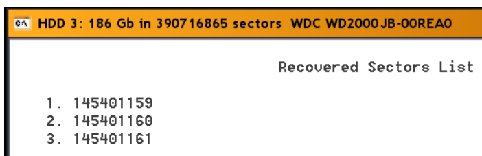
Рис. 4.27. Список восстановленных дефектных секторов на винчестере WDC WD2000JB-00REA0 (серийный номер WD-WMANK488829, версия 20.00K20, объемом 200 Гбайт)
