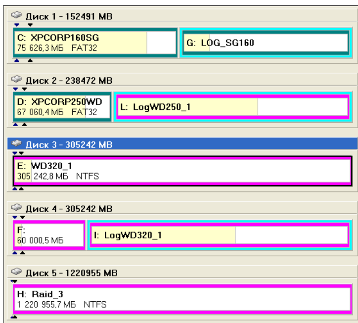
Рис. 3.55. Карта дисковой подсистемы, на которой Диск 3 является испытываемым диском фирмы Seagate с объемом памяти 320 Гбайт (модель ST3320820AS, серийный номер 9QF83WPK)
