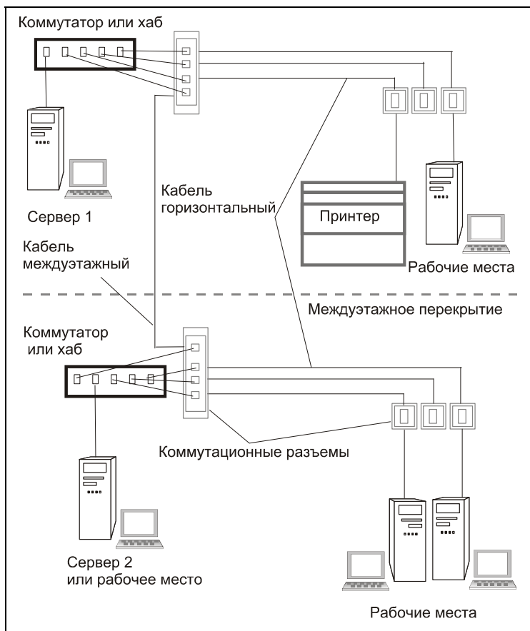
Рис. 3.1. Примерный вариант организации сети в одном здании
