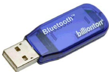
Рис. 1.29. Bluetooth-адаптер Billionton USBBT02-X
