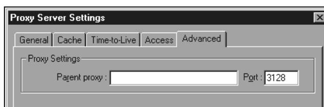
Рис. 3.27. Установка порта прокси-сервера
