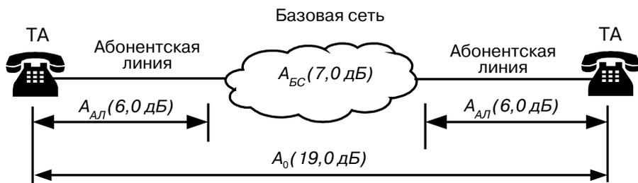
**Рис. 8.4.** Распределение остаточного затухания в цифровой телефонной сети
