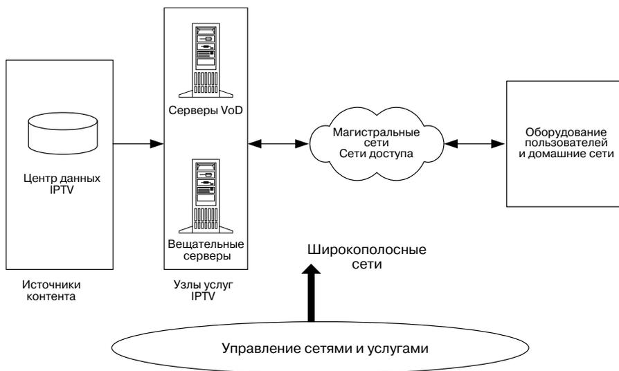
**Рис. 26.5. Упрощенная архитектура системы IPTV**
