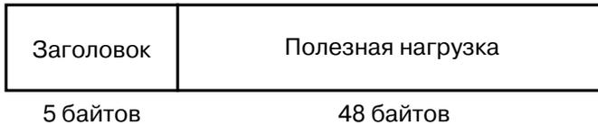
**Рис. 22.4. Структура ячейки АТМ**
