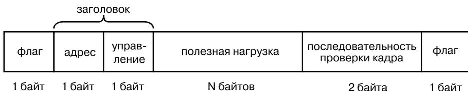
**Рис. 22.2. Формат информационного кадра в протоколе X.25**
